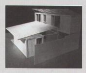
Sein Prototyp beruht auf einer einfachen Kombination von Elementen, aus wasserbeständigen Corten-Stahl-Containern und einem Baukasten von Teilen: sechs Typen von Fenstern und Türen, Dachträger, Sonnenstoren und innere Trennwände. Ortsübliche Materialien werden für die Mauer zwischen Hof und Strasse verwendet.
