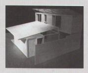
Sein Prototyp beruht auf einer einfachen Kombination von Elementen, aus wasserbeständigen Corten-Stahl-Containern und einem Baukasten von Teilen: sechs Typen von Fenstern und Türen, Dachträger, Sonnenstoren und innere Trennwände. Ortsübliche Materialien werden für die Mauer zwischen Hof und Strasse verwendet.
