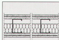
Hohe Dämmung: FERMACELL Montagewand 1 S 31, Stahl-Unterkonstruktion, doppelt beplankt. R_{w,R} 57 dB, F 90-A.
