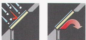
VELUX THERMO-STAR Isolierglasscheiben sind gasgefüllt, zweifach versiegelt und haben einen K-Wert von 1,3 W/m<sup>2</sup>K. Das innere Glas ist mit einer Edelmetallbeschichtung versehen. Das äußere Glas (ESG) ist gehärtet und bietet einen 99 prozentigen Hagelschutz.
