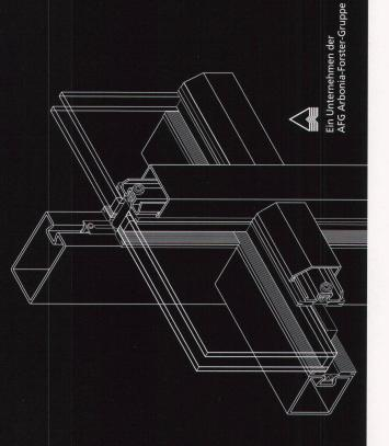
Das wärmegedämmte Pfosten-/Riegel-System aus Profilstahlrohren für verglaste Fassaden.
