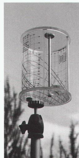
Der neue «Heliochron international» wurde so weiterentwickelt, dass er auf der ganzen Welt benutzbar ist, indem die Sonnenbahn-Folien ausgewechselt werden können und man für jede geographische Breite die entsprechende Folie verwenden kann. Auch der «Heliochron CH», für die Schweiz konzipiert, kann auf das neue System erweitert werden.
