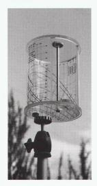
Der neue «Heliochron international» wurde so weiterentwickelt, dass er auf der ganzen Welt benutzbar ist, indem die Sonnenbahn-Folien ausgewechselt werden können und man für jede geographische Breite die entsprechende Folie verwenden kann. Auch der «Heliochron CH», für die Schweiz konzipiert, kann auf das neue System erweitert werden. Dr. A. Mützenberg AG, 9470 Buchs
