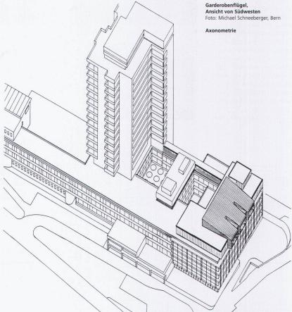
Die Aufstockung ist als solche erkenn- und lesbar. Sie setzt sich aus dem eingeschossigen, flachen, verglasten Körper und dem daraus herausragenden, gewölbten, mit Blech verkleideten Volumen zusammen. Die medizintechnische Nutzung des Innern ist ablesbar. Die äussere Glashaut als wesentlicher Bestandteil der Architektur wurde vom Basler Kunstmaler Gido Wiederkehr gestaltet. Er hatte in seinem Entwurf die bauphysikalischen und benutzerspezifischen Anforderungen zu berücksichtigen.
