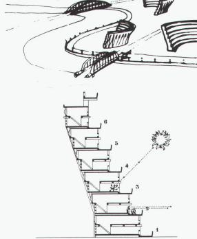
Um eine Mischung verschiedener doppelgeschossiger Wohntypen zu ermöglichen, nimmt der Querschnitt nach oben ab. Die unbedeckte Horizontalerschliessung greift das Wesen einer traditionellen Quartierstrasse auf. Um den arenaartigen Aussenraum verlaufend, definieren die kollektiven Terrassenräume den Zusammenhang zwischen Individuum und Kollektiv neu.
