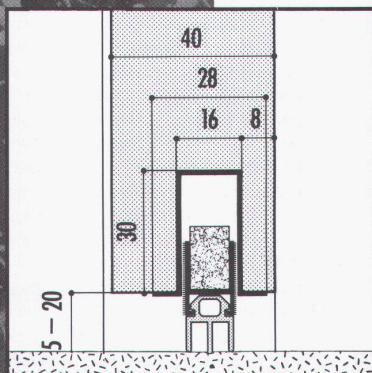
Schwellenlose Türverschlüsse von Planet schützen vor Wärmeverlust und Zugluft (Modell A3), vor Schall, Nässe und Rauch. Außerdem werden damit Räume rollstuhlgängig. Schwellenlose Türverschlüsse von Planet können einfach in jede Tür eingebaut werden. Auch nachträglich. Anruf genügt. Wir rufen zurück.
