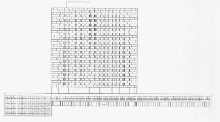
Die Fugen der Brüstungsbänder sind untereinander in einer linien-förmigen Form verschoben. Dabei entsteht eine Wechselwirkung zwischen den Fensterstorenschienen
