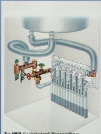
Typ HWU für Hochschrank-Wassererwärmer mit Heizelement nach unten
