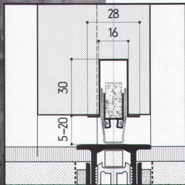
Schwellenlose Türverschlüsse von Planet trennen laut und leise (Modell WS, hier in idealer Kombination mit Boden-Trennschiene BT), schützen vor Wärmeverlust und Zugluft, vor Rauch und Nässe und machen Räume rollstuhlgängig. Schwellenlose Türverschlüsse von Planet können einfach in jede Tür eingebaut werden. Auch nachträglich. Anruf genügt. Wir rufen zurück.
