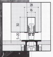
Schwellenlose Türverschlüsse von Planet trennen laut und leise (Modell WS, hier in idealer Kombination mit Boden-Trennschiene BT), schützen vor Wärmeverlust und Zugluft, vor Rauch und Nässe und machen Räume rollstuhlgängig. Schwellenlose Türverschlüsse von Planet können einfach in jede Tür eingebaut werden. Auch nachträglich. Anruf genügt. Wir rufen zurück.
