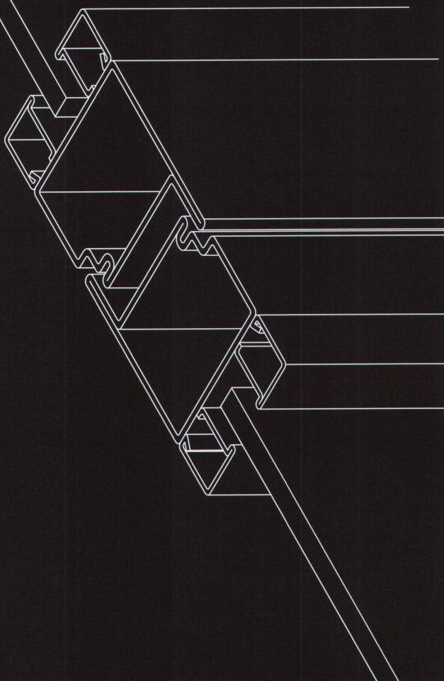
**Das weltweit erste flächenbündige Profilstahlrohr-System aus Edelstahl. Mit Doppel-dichtung für verglaste Türen und Abschlüsse.**
