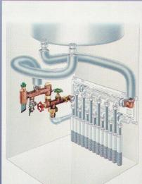
Typ HWU für Hochschrank-Wassererwärmer mit Heizelement nach unten
