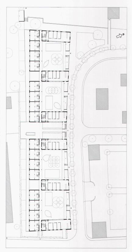
**Situation und Grundriss Erdgeschoss** Situation et plan du rez-de-chaussée Site and ground floor plan
