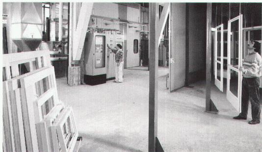
Die verwendeten waserverdünnbaren Acrylate unterliegen zudem praktisch keiner Alterung und Versprödung und sind deshalb auch qualitativ konventionellen Lacken überlegen. Die computergesteuerte elektrostatische Beschichtung führt zudem zu einer gleichmässigen Schichtdicke und einer optimalen Lackierqualität, insbesondere auch in den Bohrungen und an den Kanten. Damit kann sich Megert dank der neuen Anlage auch qualitativ von den meisten Konkurrenten abheben.
