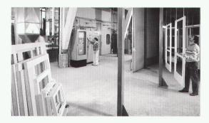
Die verwendeten wasserverdünnbaren Acrylate unterliegen zudem praktisch keiner Alterung und Versprödung und sind deshalb auch qualitativ konventionellen Lacken überlegen. Die computergesteuerte elektrostatische Beschichtung führt zudem zu einer gleichmässigen Schichtdicke und einer optimalen Lakkierqualität, insbesondere auch in den Bohrungen und an den Kanten. Damit kann sich Megert dank der neuen Anlage auch qualitativ von den meisten Konkurrenten abheben.
