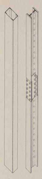
Geschweisste Stahlstütze der Clarté, 1932. und genietete Stahlstütze der (Maison de Verre), 1932
