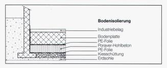
Die ultraleichten Glasschaumkugeln garantieren eine hohe thermische Dämmung. Sie sind formstabil, unbrennbar und biologisch hochwertig.
