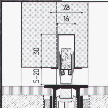
Schwellenlose Türverschlüsse von Planet trennen laut und leise (Modell WS, hier in idealer Kombination mit Boden-Trennschiene BT), schützen vor Wärmeverlust und Zugluft, vor Rauch und Nässe und machen Räume rollstuhlgängig. Schwellenlose Türverschlüsse von Planet können einfach in jede Tür eingebaut werden. Auch nachträgl. Anruf genügt. Wir rufen zurück.
