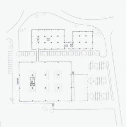
Die Maschinenfabrik in allen Bauetappen, mit Stahlbausystem «Maxi» ausgeführt L'usine de construction mécanique dans toutes ses étapes, exécutée à l'aide du système de construction «Maxi» All phases of the machine factory were realized with the help of the "Maxi" steel construction system
