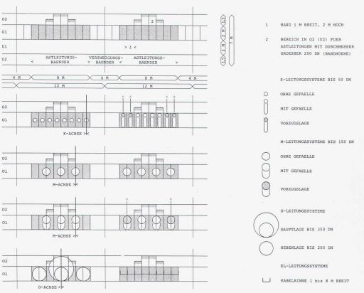
Lage der Astleitungen im Decken-Lage der Astiettungen im Decken-hohlraum. Entsprechend ihrem Querschnitt werden K-Leitungs-systeme (kleine Querschnitte, wie z.B. Wasserleitungen, Heizleitun-gen), M-Leitungssysteme (mittlere Querschnitte, wie Abwasserleitungen), G-Leitungssysteme (grosse Querschnitte, vor allem Lüftungsleitungen) und EL-Leitungssysteme (Elektrokabelrinnen) unterschieden. Ein Leitungssystem belegt je nach Klassifizierung ein, zwei oder meh-
