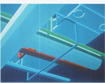
Installationsschacht mit Stammleitungen verschiedener Medien; dargestellt in der Armilla-Planungsgeometrie (oben) und eingebaut in einem Midi-Rasterfeld (unten) Gaine d'installation avec conduites d'amenée pour divers fluides; représentation en géométrie de planification Armilla (en haut) et intégrée dans une travée de réseau Midi (en has)
