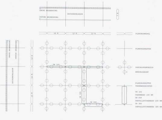
Planungsgeometrie mit schemati-schem Schnitt durch den Decken-hohlraum
