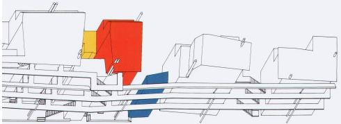
Otrassenseite mit dem vom Haus abgesetzten, geschützten Laubengang / Vue du côté rue avec coursive couverte détachée du volume / Elevation facing the road with the sheltered access balcony set apart from the house
