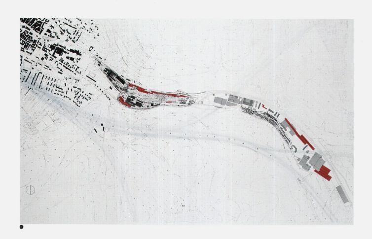
Projektstudie, Übersichtsplan unteres Albtal; rot: neue Baustrukturen; hellblau: überlagertes und verschobenes Strömungsbild der Talwinde / Etude d'avant-projet, plan d'ensemble de la basse-vallée de l'Alb; en rouge: les nouvelles constructions; bleu ciel: lignes d'écoulement et de turbulence des vents locaux / Project design, general plan of the lower Alb Valley; red: new building structures; light blue: superimposed and shifted flow configuration of the valley
