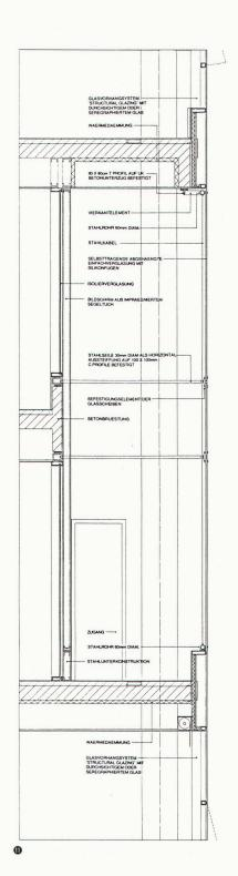
• Vertikalschnitt Fassadendetail / Coupe verticale, détail de façade / Vertical section with detail of the façade
