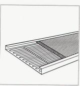
Das System beruht auf einem feinen Geflecht von Kunststoffrohren. Das darin zirkulierende Wasser kühlt gleichmässig den gesamten Deckenbereich. Dies garantiert nicht nur ein behagliches Raumklima ohne Lufturbulenzen, eine solche Bauteilkühlung ist auch wesentlich energiegünstiger als herkömmliche Klimasysteme.
