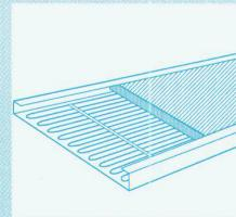
Deckenverputz ist möglich. Damit behält der Architekt im Neubau die volle Gestaltungsfreiheit im Deckenbereich. In bestehenden Bauten lässt sich die Kühldecke auch nachträglich ohne Aufwand montieren. Interessiert? Dann verlangen Sie unsere Unterlagen!
