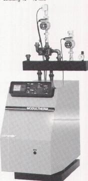
Das Geheimnis der ARZ-Flamme: die Rückführung von Abgasen im Brennerkopf bewirkt tiefe Flammentemperatur, wodurch die Bildung von NOx drastisch reduziert wird.
