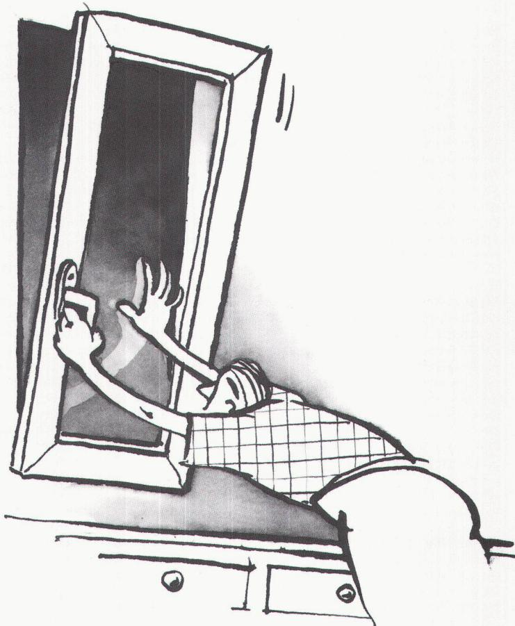
**Euroferm Vento, der Fensterverschluss mit drei gesicherten Öffnungsstellungen: Wohldosiertes Lüften ohne auf- und zuschlagenden Flügel.**
