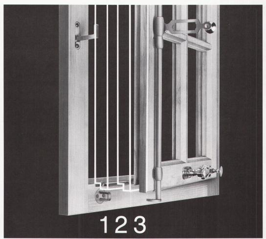
Der Einbau ist in neue oder bestehende Fenster mit einer 1. Flügelfalztiefe von mindestens 20 mm und einer Falzluft von 4, 11 oder 12 mm möglich.
