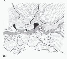
Parzellierung und Stadtstruktur werden durch die Drainagegräben bestimmt / Parcelles et structure urbaine sont définies par les fossés de drainage / Parcellation and urban structure are determined by drainage ditches
