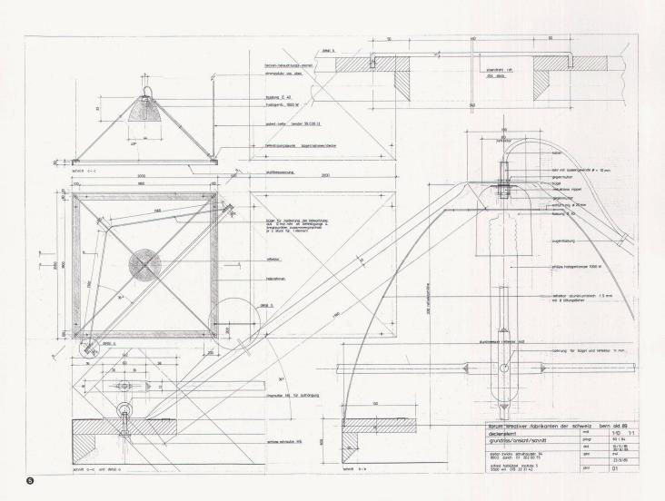
**6** Detailplan Beleuchtungselement/Plan de détail élément d'éclairage
