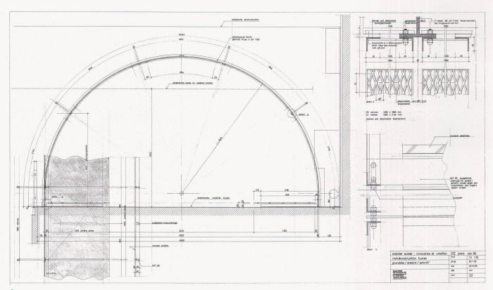
Detailplan Streckmetall-Tunnel/Plan de détail tunnel en métal déployé
