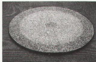
Durch das neue Imprägnierverfahren erhöhte sich die Gesamtwertung der Aussehensveränderung beim Stuhlrollentest der Empa auf die Note 4 (Empa-Test Nr. 107625 vom 3.10.1989).
