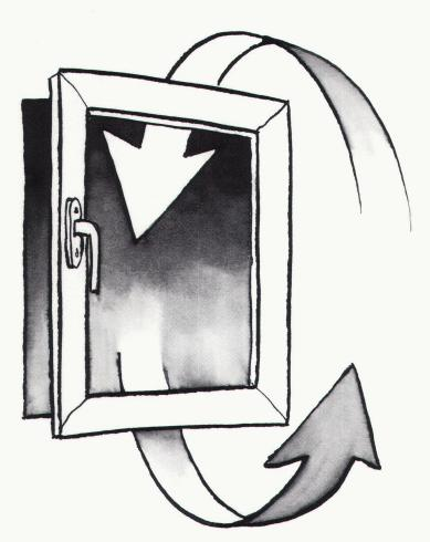
Euroferm Vento, der Fensterverschluss mit drei gesicherten Öffnungsstellungen: Wohldosiertes Lüften ohne auf- und zuschlagenden Flügel.
