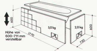
sen kann das Element direkt auf Beton oder auf vorhandene Unterlagsböden montiert werden. Das Material wird mit einfachen Werkzeugen wie Messer oder Säge zugeschnitten. Die Anschlüsse und Stösse werden mit Silikon verklebt, was Schallübertragungen und Spannungen im Wan-nenbereich verhindert.
