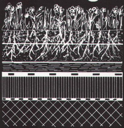
**FORMFLOR** bietet einen optimalen Wasser-Luft-Haushalt für Schräg-, Flach-, und vertikale Begrünung.
