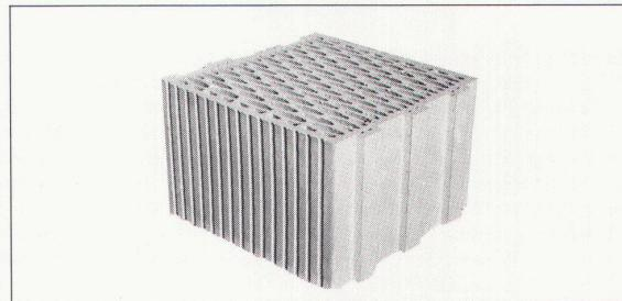
Die vielen hunderttausend luftgefüllte Poren erwärmen sich; der Baustein funktioniert als Wärmespeicher und als Wärme-/Schalldämmer zugleich. Er schafft behaglich-ausgeglichene Wohntemperatur bei stark reduziertem Energieverbrauch. Die Baukosten (Arbeitszeit, Baustein und Mörtel) liegen niedriger als beim konventionellen Backsteinmauerwerk.
