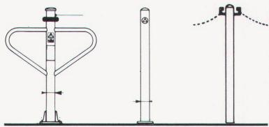
Umfassendes Typenprogramm: fest montiert, zum Herausheben, zum Umlegen, mit Absperrketten.
