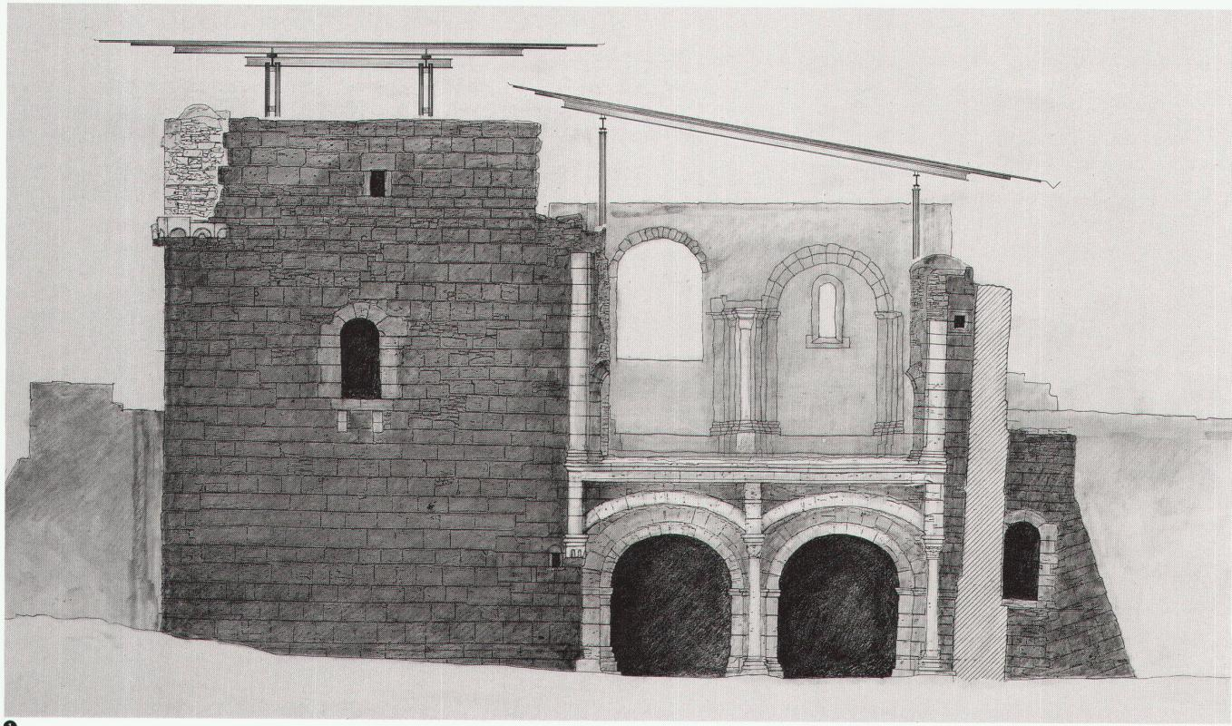
Im Ausschreibungstext zum Plangutachten für die Sicherung der Ruine in der Kaiserpfalz in Gelnhausen wird zum Ausdruck gebracht, dass eine Überdeckung entworfen werden soll, die jederzeit reversibel sein muss. Es heisst dort weiter, dass dieses «Schutzhause» Torturm und Torkapelle einschliesslich ihrer offenen Mauerkrone überdecken soll, wobei aus denkmalpflegerischen Gründen Eingriffe in die vorhandene Bausubstanz weitgehend zu vermeiden sind.
