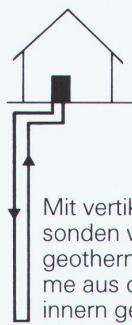
Mit vertikalen Erdsonden wird die geothermische Wärme aus dem Erdinnern genutzt. Die bis zu 120 m tiefen Sonden profitieren von der konstanten Erdtemperatur von 8–10°C.
