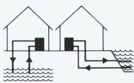
Bei vorhandenem Grund- oder Oberflächenwasser wird in einem Kreislauf dem Wasser Wärme entzogen. Pro Kubikmeter Wasser ca. 20 000 kJ (5000 kcal) Nutzwärme.
