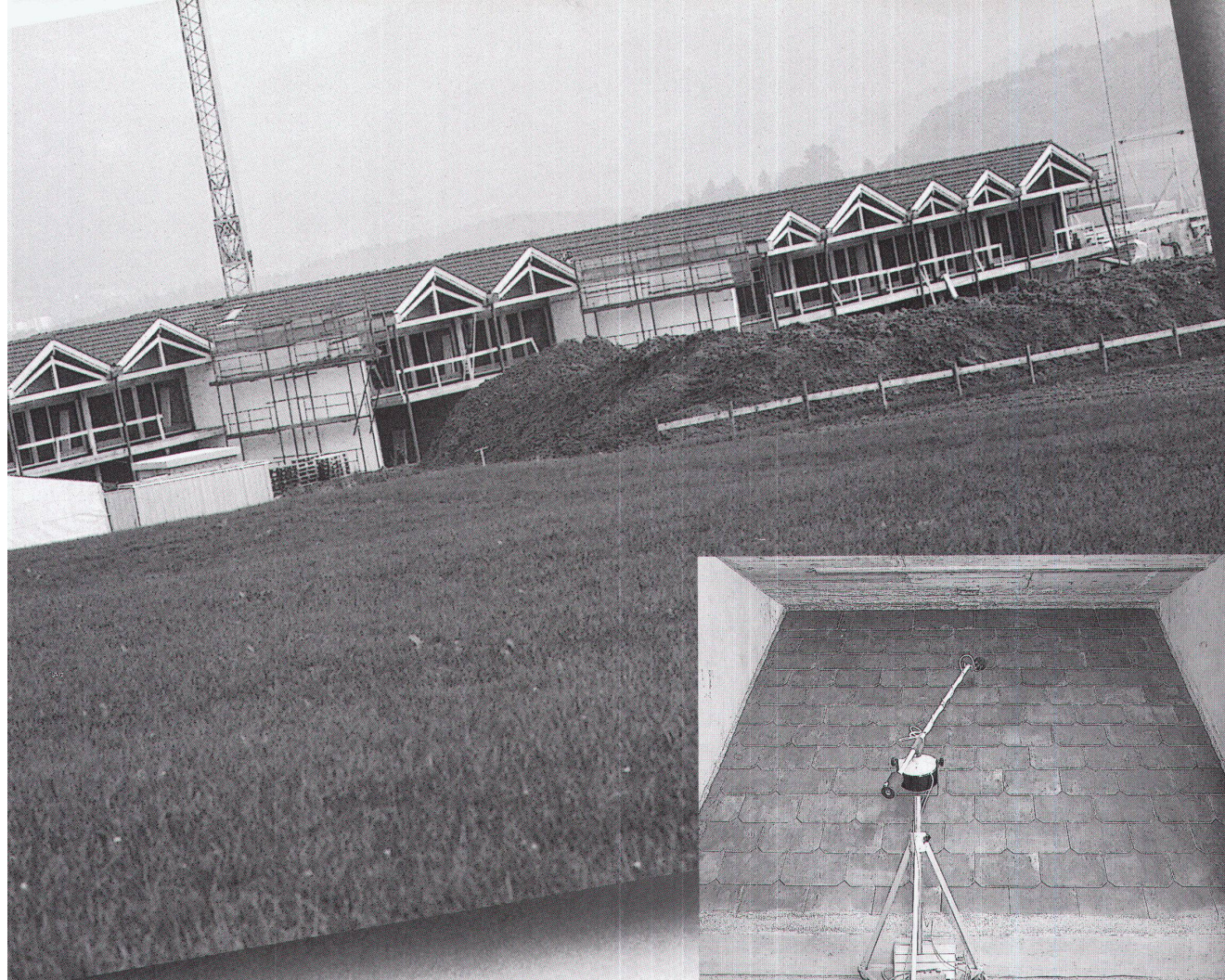
Luftschallprüfung am Grossmodell EMPA Zürich
