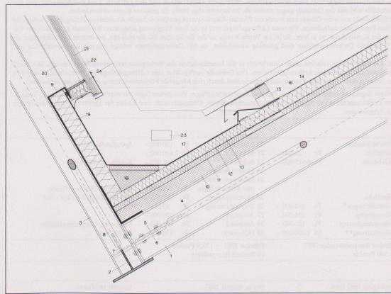
Nordfassade/Anschluss an die Decke über Erdgeschoss: 1 Fassadenträger IPE 140, 2 Stahlblech als horizontale Abstützung, beweglich an der Decke über Erdgeschoss befestigt, 3 Brandschutz: 4cm Vermipan, 4 Isolierverglasung (3fach) VSG, 5 Glashalteprofile und Abdeckleiste aus Aluminium, 6 isolierte Zarge, 7 Lüftungsflügel, 8 Gestänge zum Öffnen der Lüftungsflügel, 9 Druckluftzylinder, 10 Gebäudekante
