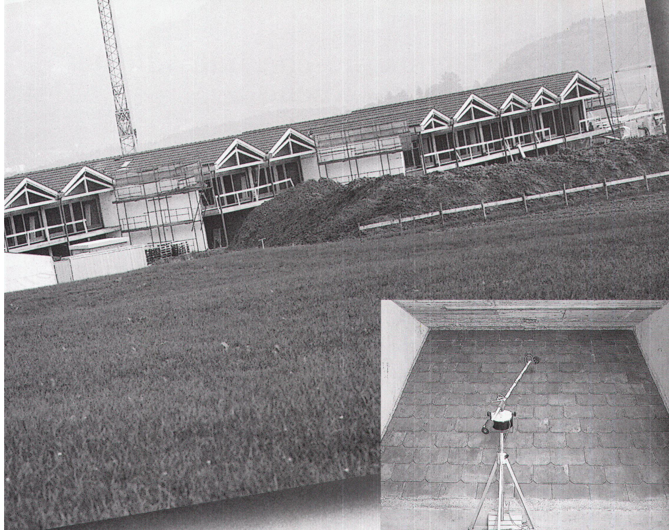
Luftschallprüfung am Grossmodell EMPA Zürich
