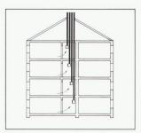
Zentrallüftung über Sammelschacht. Vorteil: Einfache Installation, da nur ein Sammelschacht. Nachteil: Da ein Dauerbetrieb notwendig ist, ergibt sich eine grosse Energieverschwendung. Eine individuelle Steuerung ist nur mit grossem Aufwand teilweise möglich. Es besteht die Gefahr von Geruchs- und Lärmemissionen.
