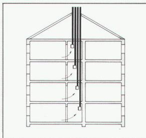
**Zentrale Lüftung über Sammelschacht.** Vorteil: Einfache Installation, da nur ein Sammelschacht. Nachteil: Da ein Dauerbetrieb notwendig ist, ergibt sich eine grosse Energieverschwendungen. Eine individuelle Steuerung ist nur mit grossem Aufwand teilweise möglich. Es besteht die Gefahr von Geruchs- und Lärmemissionen.
