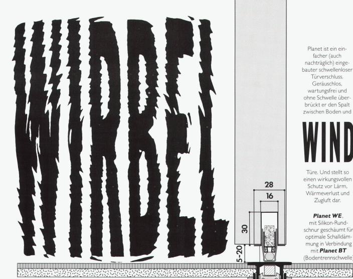
Planet ist ein einfacher (auch nachträglich) eingebauter schwellenloser Türverschluss. Geräuschlos, wartungsfrei und ohne Schwelle überbrückt er den Spalt zwischen Boden und
