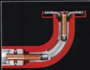
Schnitt durch 90° Bogen eines Handlaufs zeigt korrosionsgeschützten Stahlkern und Befestigung.
