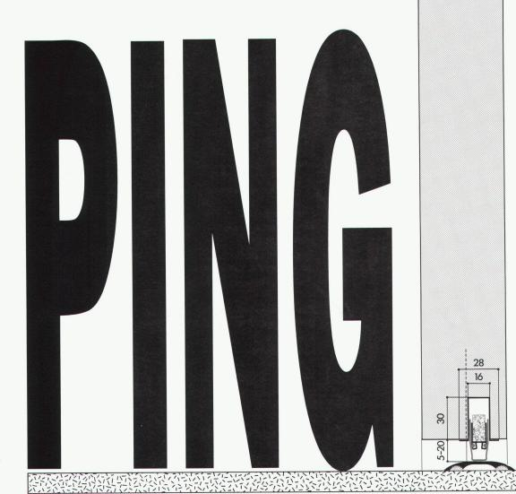
Planet ist ein einfacher (auch nachträglich) eingebauter schwellenloser Türverschluss. Geräuschlos, wartungsfrei und ohne Schwelle überbrückt er den Spalt zwischen Boden und
