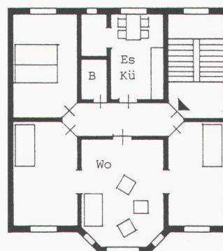
6 7 Enfilade zweier Zimmer, Grundriss eines Berliner Wohnhauses, ca. 1910; direkte Zimmerverbindungen; Durchblicke und Nutzungsflexibilität / Enfilade de deux pièces / Two rooms in series
