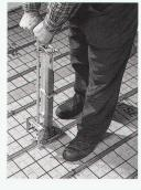
Trittschallprüfung mit Klopfgeräten unter realen Baubedingungen (Unterlagsboden vollflächig, lange Belastungsdauer) in der EMPA Zürich.
