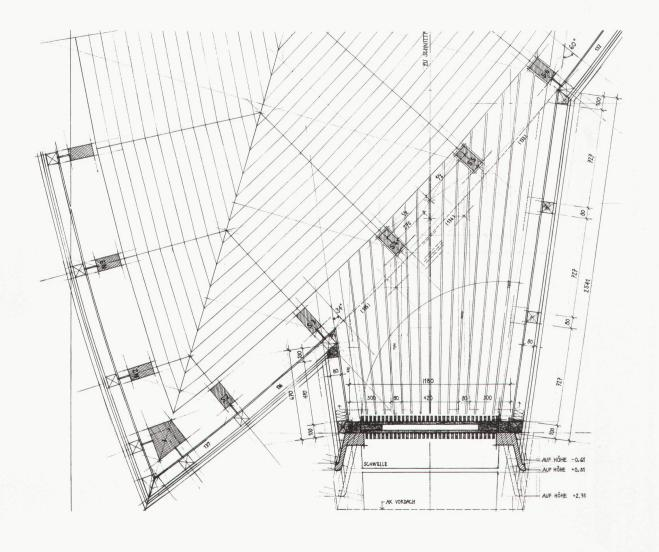
Werkplan des Eingangsbereiches / Plan d'exécution de la zone d'entrée / Structural plan of the entrance area
